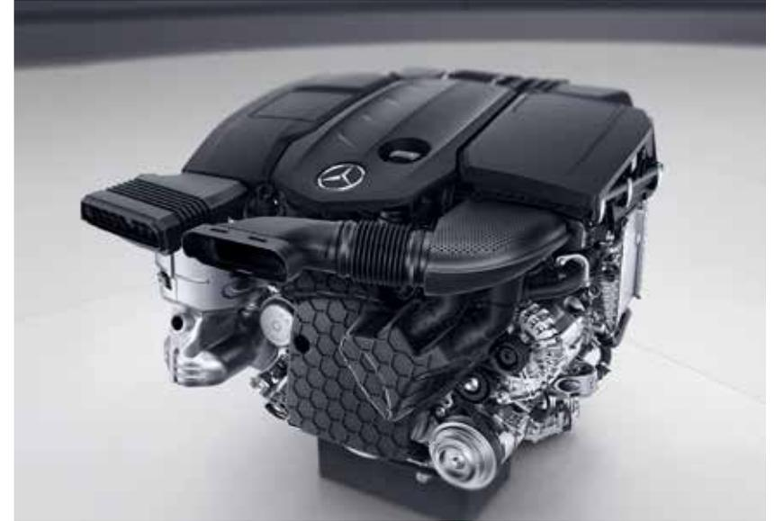
Basierend auf dem **Mercedes-Benz Sprinter**, mit modernster Technik und Technologie, für Leistung, Langlebigkeit und Sicherheit. Mercedes-Benz 2.0L-Dieselmotor mit 190 PS, gekoppelt mit einem G-TRONIC 9-Gang-Automatikgetriebe.
